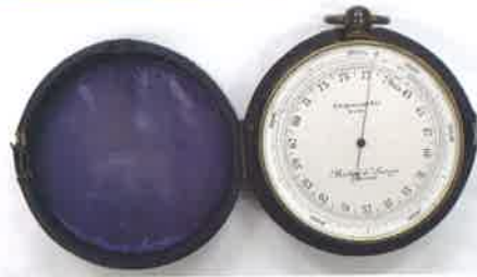
アネロイド気圧計 (気象庁気象測器検定試験センター所蔵)
